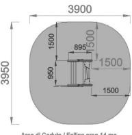
Area di Caduta / Falling area 14 mq Altezza Max di Caduta / Maximum falling height 9.80m
