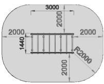
Area di sicurezza / Safety area 35.5mq Altezza Max di Caduta / Max falling height 2.1m
