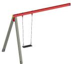
NR 1 Realizzata con trave superiore in acciaio verniciato e gambe in legno lamellare impregnato. Tavoletta in gomma ad alto assorbimento d urto rinforzate all'interno da una struttura in metallo. Catene in tondo di acciaio zincato a caldo a maglia stretta che ne impedisce l'intrappolamento delle dita. Snodi realizzati in acciaio zincato e verniciato
