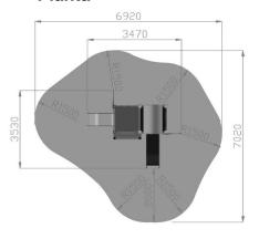
Area di Sicurezza / Safety area 30mq Altezza Max di Caduta / Max falling height 0.9m
