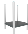
xQ-4_ALU - NG Torre h40 senza tetto NR 1 Torre altezza 40cm Realizzata con nr 4 montanti in alluminio EN EV6060 anodizzato con profilo speciale 90mm x 90mm con spigoli arrotondati raggio 32mm e anime interne di rinforzo spessore minimo 2,7 mm tutta la bulloneria e fissaggi in acciaio inox, 1 pianale dimensione 1040mm x 1040mm realizzato con profili in acciaio zincato e verniciato e pedana in plastica riciclata al 95% seconda vita spessore 25mm.
