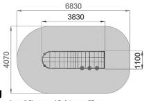
Area di Sicurezza / Safety area 25mq Altezza Max di Caduta / Max. falling height 0.90m
