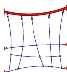
PAL-02 - Kit palestra lineare NR 1 realizzata con struttura portante in legno lamellare impregnato a pressione in autoclave, rete di arrampicata in corda di acciaio rivestita e fissata alla struttura portante mediante bulloneria passante a scomparsa, spalliera verticale con pioli in acciaio inox, e fune di arrampicata con pioli
