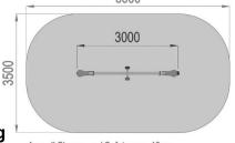
Area di Sicurezza / Safety area 19mq Altezza max di caduta / Max falling height 0.60m
