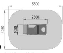
Area di Sicurezza / Safety area 21mq Altezza max di Caduta / Max falling height 0.0m
