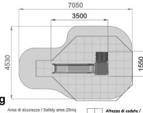
Altezza di caduta / Falling height: 1400 mm
